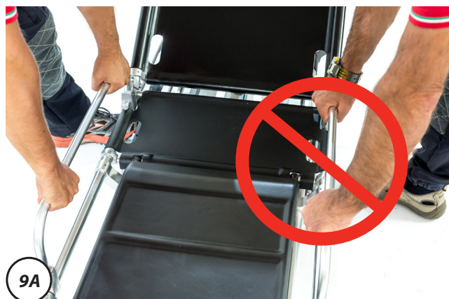
** Figura 9 - A: NON CORRETTO sollevamento della barella B: CORRETTO sollevamento della barella impugnando il telaio principale
