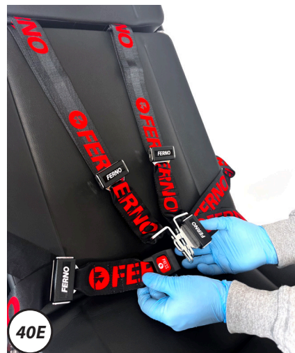
Figura 40 - Installazione parte inferiore della cintura a quattro punti
