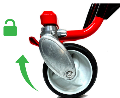
Figura 13: Blocco ruote posteriori
