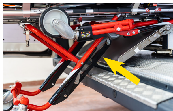
Figura 5 - Sistema di sblocco meccanico gambe posteriori
