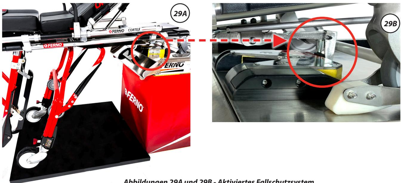
Abbildungen 29A und 29B - Aktiviertes Fallschutzsystem.
