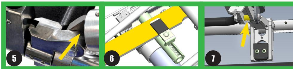
Abbildung 49 - Zu schmierende Teile/Bereiche
