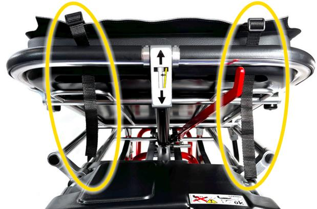
Abbildung 36 - Durchzug der Riemen durch die Langlöcher der Krankentrage
