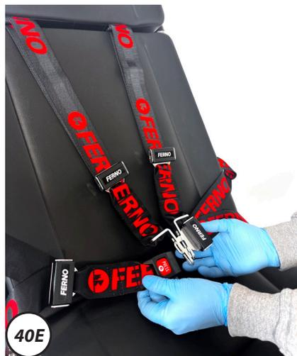
Abbildung 40 - Anbringen des unteren Teils der Hosenträgerbegurtung
