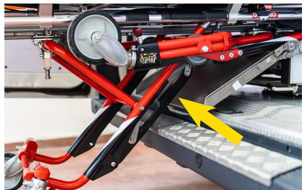
Abbildung 5 - Mechanisches Entriegelungssystem der hinteren Stützbeine
