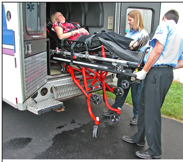
Figure 20 - Une fois les jambes du côté contrôle dépliées, contrôler l'indicateur pour s'assurer qu'elles sont bien bloquées.
