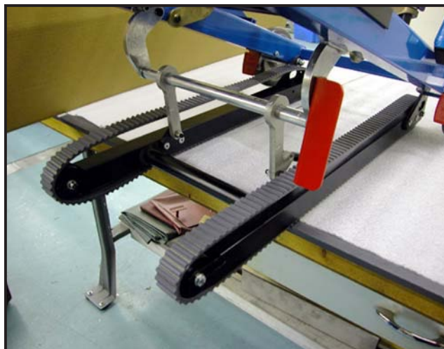
Figura 34 - Sedia pronta per la procedura di tensionamento (vedere il punto 1 per la posizione alternativa)
