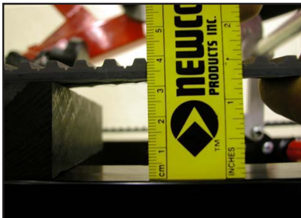
Figura 37 - Verificare la tensione con la sedia posata sul pattino su un piano di lavoro
