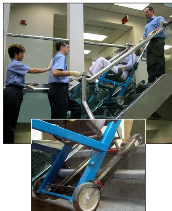
Figura 25 - Stabilire l'angolo di scivolamento
