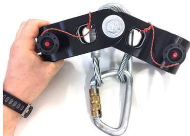
Unire le asole del cavo di acciaio sotto la testa del bipode tramite un connettore a moschettone in acciaio EN362 come in figura a lato.
