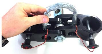
Passare il cavo di acciaio attorno al perno centrale che collega la testa del bipode.
