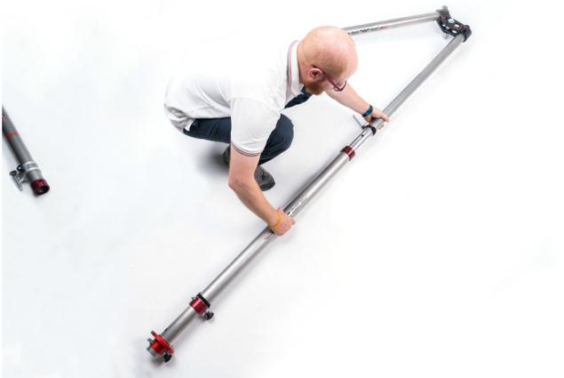
Führen Sie das Bein (ausziehbares Element) in das feste Element ein.
