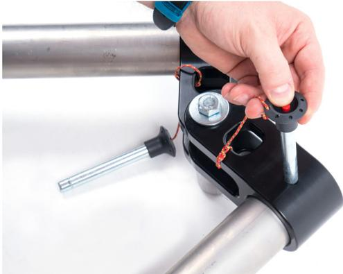
Halten Sie den Kopf an den Bohrungen der Beine fest und stecken Sie den Bolzen ein.
