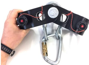
Verbinden Sie die Ösen des Stahlseils unter dem Kopf des Zweibeins mit einem Verbinder mit Karabinerhaken aus Stahl nach EN362 (siehe Abbildung hier nebenan).
