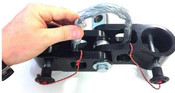
Führen Sie das Stahlseil um den mittleren Sperrbolzen des Zweibeinkopfteil.
